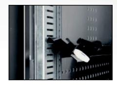
Le système EASY CLICK permet de régler la hauteur des plateaux de la machine simplement et rapidement sans outils.
