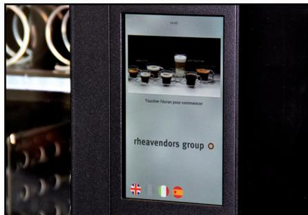
Le display tactile permet l'affichage du clavier de sélection, du mode d'utilisation de la machine et la diffusion d'informations sur les produits vendus (calories, allergènes ou promotions en cours), en format images et vidéos.
