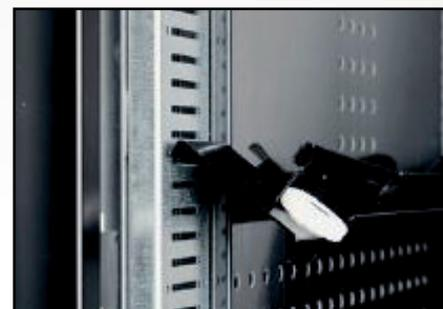
Le système EASY CLICK permet de régler la hauteur des plateaux de la machine simplement et rapidement sans outils.
